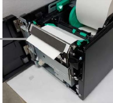
13. Passen Sie den Andruck des Druckkopfs mit dem Kopfpositionshebel an die Stärke des Druckmaterials an.
