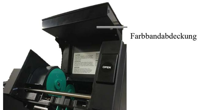
5. Setzen Sie den Kern der Aufnahmerolle in die Halterungen (Aufnahmeseite) ein wobei die Nut des Kerns in der Nase der Farbbandhalterung sitzen muss.
