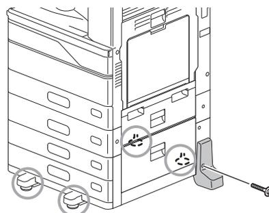
Vor dem Bewegen des Systems sollte das vordere Stabilisierungselement entfernt werden. Nach dem Bewegen des Systems muss dieser wieder montiert werden.
