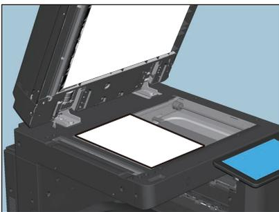
Halten Sie die Abdeckung mindestens 60 Grad geöffnet, damit das Original korrekt erfasst werden kann. Bei einigen Modellen müssen Sie die Größe des Originals manuell festlegen.
