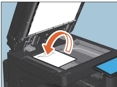
Die Unterkante des Originals weist zur Systemvorderseite. Richten Sie das Original an der linken oberen Ecke des Vorlagenglases aus. Wenn Sie das Original im Querformat auflegen, positionieren Sie dessen Oberkante an der linken Vorlagenglaskante.
